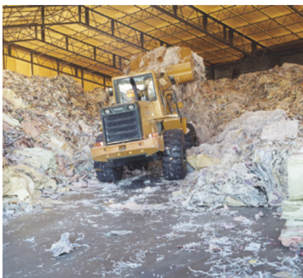
王子製紙富士工場の古紙置き場。品質を均等にするために、古紙をかき混ぜている様子。
